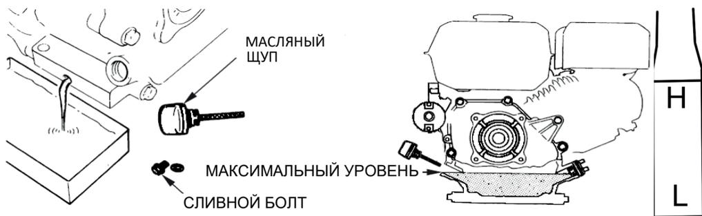
4) Установите и затяните масляный щуп. Рекомендуемое моторное масло: Моторное масло для 4-тактного двигателя. Масло категории SE или SF или аналоги, SG, SAE 10W-30/10W-40 по классификации API (эксплуатационная характеристика масла по классификации Американского нефтяного института).
