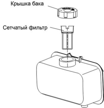
2) Снимите крышку топливного бака и сетчатый фильтр топливного бака, сливную пробку бака и уплотнительное кольцо. Ослабьте гайки и снимите кран, вытащите топливный фильтр. Установите новый топливный фильтр и прокладку через топливную горловину. Установите топливный кран на место, используя гайки. Установите прокладку и затяните сливную пробку топливного бака.
