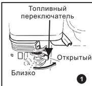
Поверните топливный переключатель в положение "включено".
