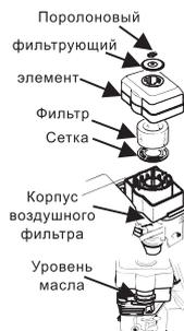
1. Снимите барашковую гайку, затем снимите колпачок и крышку воздушного фильтра.
