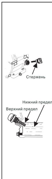
1. Снимите маслоизмерительный щуп и протрите его.
