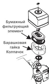
1. Снимите барашковую гайку с крышки воздушного фильтра и снимите крышку воздушного фильтра.
