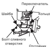
1. Поместите подходящий контейнер для бензина под карбюратор и используйте воронку, чтобы предотвратить протечку топлива. Выключите топливный переключатель.
