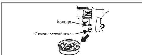
1. Отключите топливный переключатель, снимите крышку для слива топлива и снимите кольцо.
