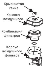
Отвинтите резьбовую рукоятку и снимите корпус воздушного фильтра.
