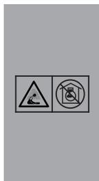
Токсичные выхлопные газы, образующиеся при использовании, такие как монооксид углерода (бесцветный, без запаха газа), могут вызывать удушье. Используйте двигатель только в хорошо проветриваемых помещениях.
